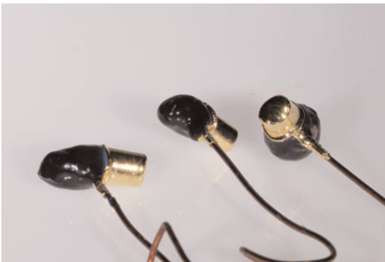
Abb. 15a und b Direkt aufgalvanisierte Sekundärteile (Galvanocopings).
