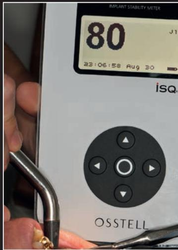
Abb. 13: Das Implantat verfügte mit 80 ISQ (Ostell) über eine sehr gute Primärstabilität.
